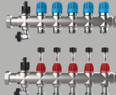
FBH-Anschlussverteiler W-4L/WS-18 für EGO-System Primäranschluss 1"ÜW fld. seitlich mit Durchflussanzeiger min/max. und THV-Einsatz für EGO-Schnellverschluss
